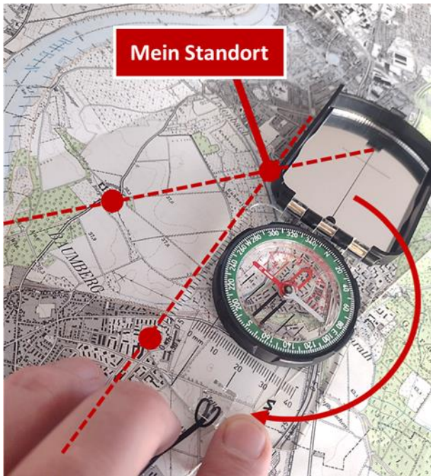
Kreuzpeilung mit einem Silva Ranger S mit Skalen für verschiedene Maßstäbe, Peilvisier und Spiegel, Foto: A. Hoogen
